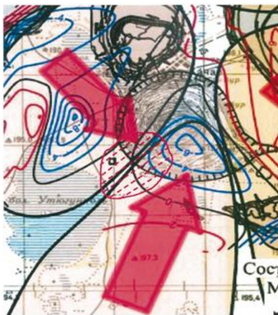
Рисунок 1.26 – Формирование области концентрации сжимающих напряжений на юго-западном борту Качарского карьера
