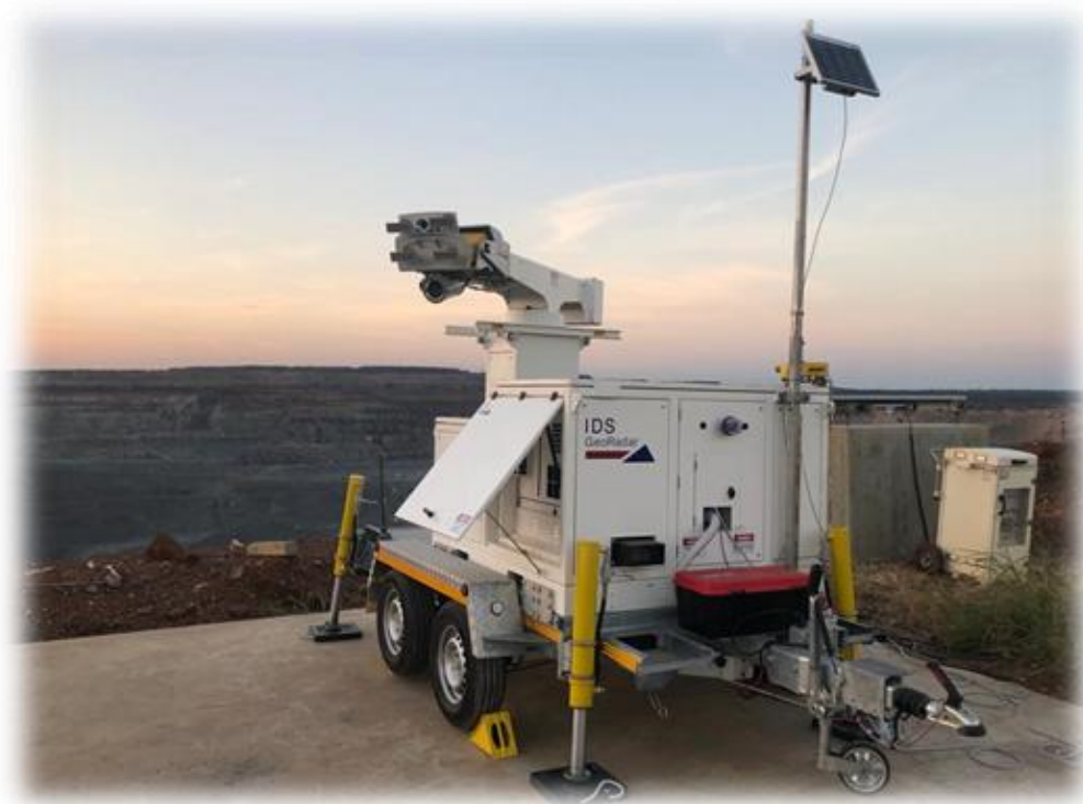
Рисунок 3.4 - Радиолокационная система (ArcSAR от IDS GeoRadar) [68]
